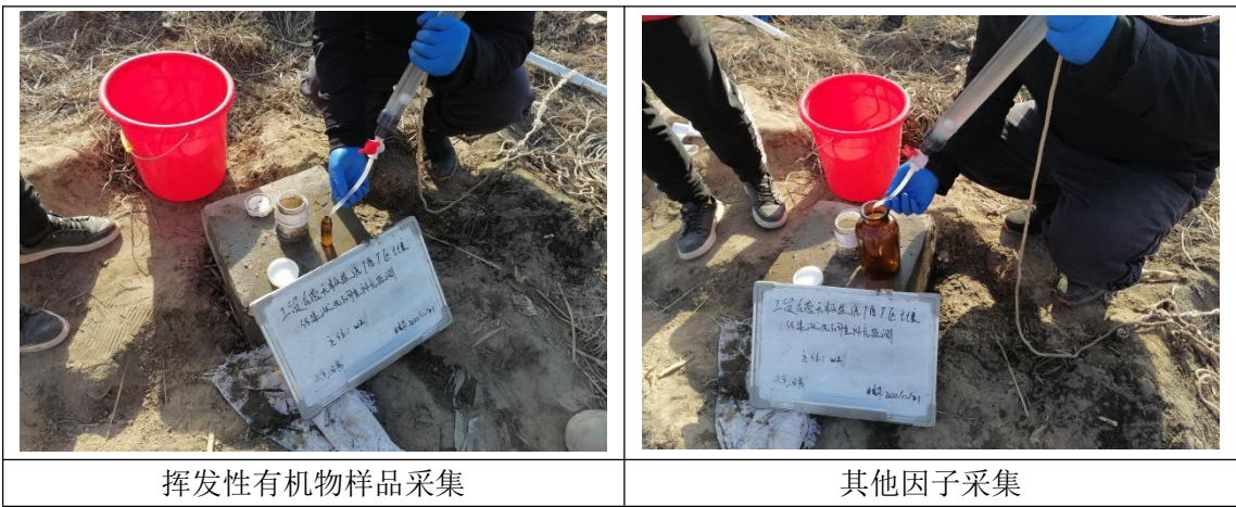
图 4.2-5 地下水样品采集照片
